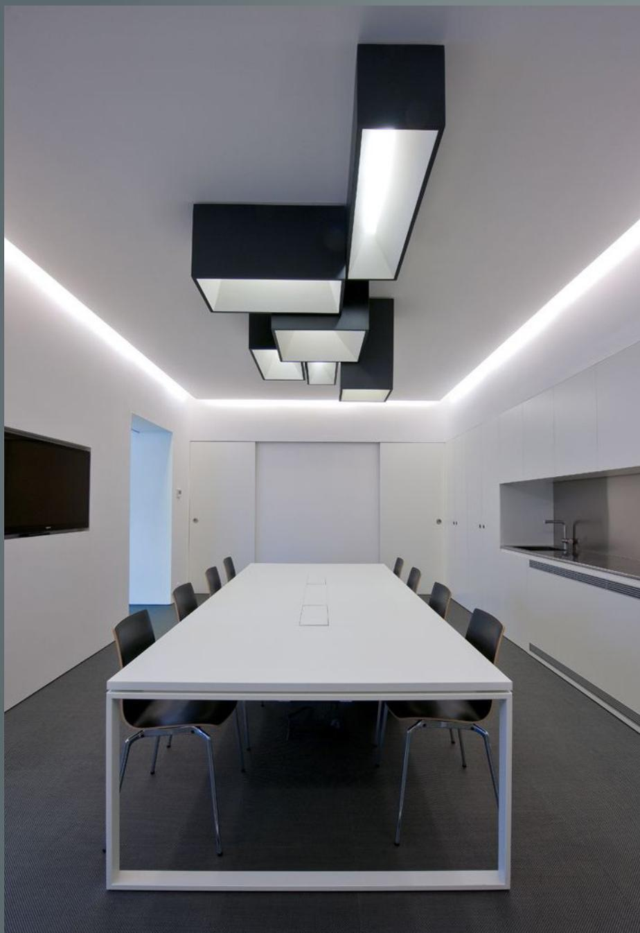
Геометрические светильники Cube обладают оригинальной системой распределения света и создают комфортное объемное рассеяное освещение. Светильники могут быть изготовлены в различных типоразмерах и собраны в интересные композиции, приятные для обозрения. По способу крепления светильники являются накладными. Оттенки корпуса и дополнительные опции обсуждаются индивидуально.
